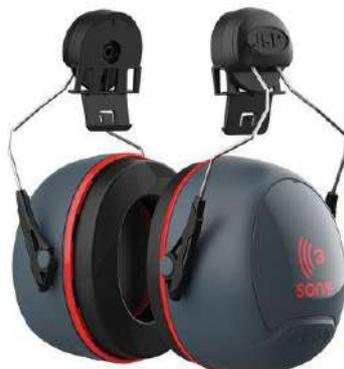
Ces coquilles antibruit JSP se montent facilement sur les casques JSP de la gamme EVO. Elles offrent une haute protection contre le bruit avec une **atténuation SNR de 36 dB**, idéales pour les environnements sonores de 112 à 117 dB. Ces coquilles pourront ainsi être utilisés au sein d'environnements de travail bruyants comme le secteur aéronautique, l'industrie minières, l'industrie papetière, l'industrie lourde et toutes les autres industries où le bruit est extrême.
