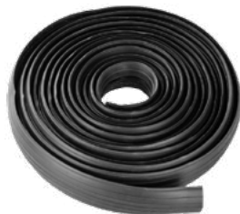
PC 2 Poids : 4,8 kgs Dimensions : 9000×64×11 mm Passage de câbles : 16×6,4 mm
